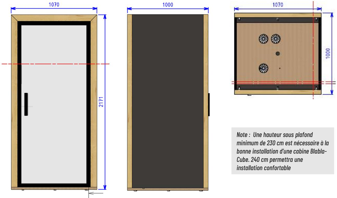
*Note : Une hauteur sous plafond minimum de 230 cm est nécessaire à la bonne installation d'une cabine Blabla-Cube. 240 cm permettra une installation confortable*
